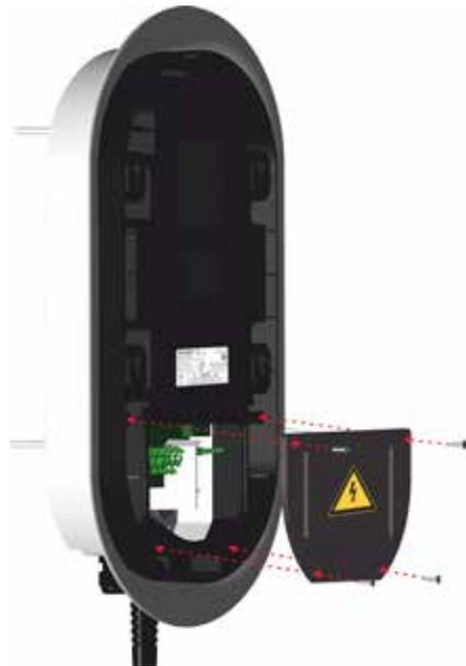
Montieren Sie die zuvor entfernte Installationsklappe mit den dazugehörigen 4 Schrauben Torx-TX 20.
