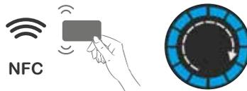
1. Halten Sie eine RFID-Karte vor das RFID-Lesegerät. Bei Erkennen der Karte dreht sich der Leuchtring 1x rechts herum.
