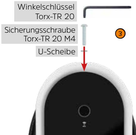
3. Oberhalb der Frontglasscheibe nun die, sich im Lieferumfang befindliche, Sicherungsschraube "Torx-TR 20 M4" und "U-Scheibe" mit dem Winkelschlüssel "Torx-TR 20" in die Gewindebuchse einschrauben.
