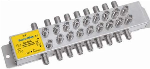
Diese in ihrer Art konkurrenzlose Baugruppe ermöglicht es, die Signale eines Verteilstammes vielfach, jeweils doppelt, abzuzweigen und nachgeschalteten Unterverteilungen zuzuführen. Die Stammeleitungen sind fast dämpfungslos, die Verstärkung der Abzweige sind schräglagenentzerrt einstellbar. Dieser Abzweiger ist bis zu 6-mal kaskadierbar, um Signale für die Unterverteilungen der Etagen eines Hochhauses oder für Häuser einer Häuserzeile bereitzustellen.
