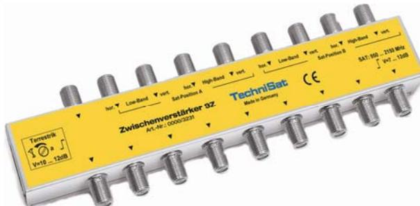
Die Verstärkungen und die fest eingestellte Schräglagenentzerrungen des Gerätes sind für den Ausgleich der Dämpfung durch Kabel und/oder Komponenten von 12 dB bei 2150 MHz ausgelegt. Die Verstärkung des terrestrischen Pfades ist einstellbar.
