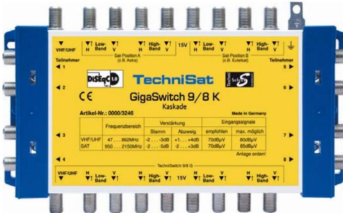
Diese Kaskadiermatrix für 8 Teilnehmer kann bei Verwendung von Zwischenverstärkern bis zu 4-mal hintereinandergeschaltet werden. Die Stromversorgung erfolgt vom GigaSwitch 9/8 G2.
