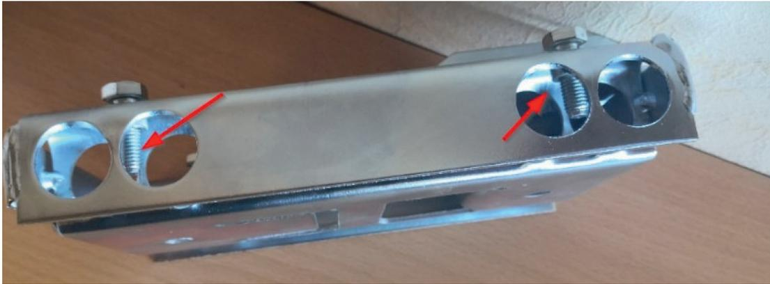
Die Streben (Rohre) werden durch die Schlitten-Öffnungen geschoben, um die Halterung an unterschiedliche Sparren-Abstände anzupassen. Die Position des Halters wird dabei durch den Druck, den die gekennzeichneten Schrauben ausüben, fixiert.
