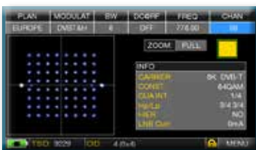
Abb. 4: DVB-T-64Q KONSTELLATION: Die Tabelle rechts zeigt alle verfügbaren Modulationsparameter
