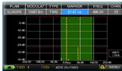
Abb. 2: GUTER EMPFANG: * Echos vorhanden, aber innerhalb des GUARD INTERVAL, aus einer Entfernung von: 1. Echo: 15 Km, 50 \mu\text{s} Verzögerung 2. Echo: 24 Km, 83 \mu\text{s} Verzögerung.
