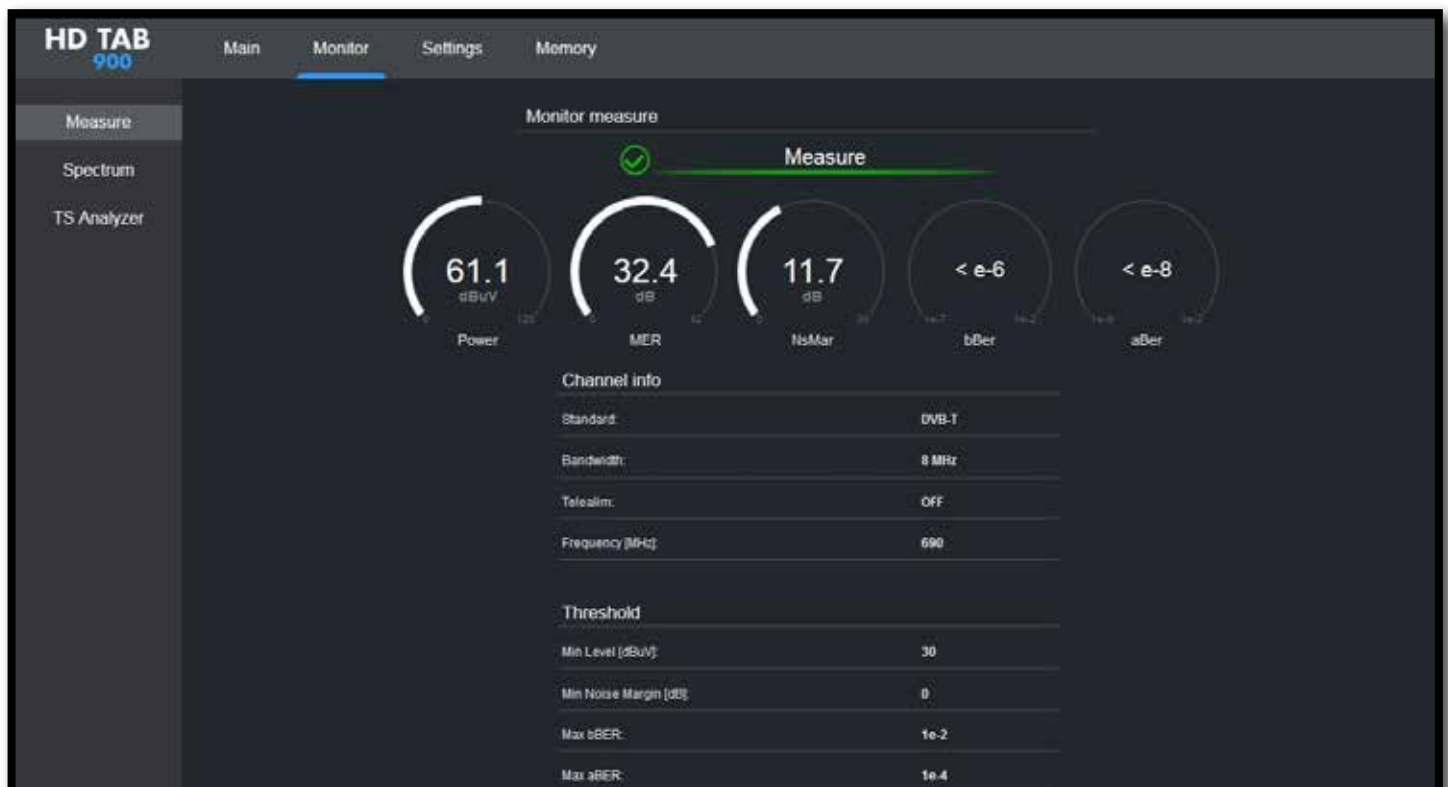
Beispiel für die Messung eines TV-Kanals (DVB-T-Standard) und zugehöriger Bildschirm von IMPULSE RESPONSE (ECHOES)
