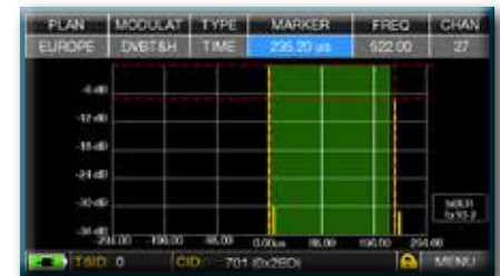
Abb. 3: SCHLECHTER EMPFANG (oder KEIN EMPFANG):* 2 Echos vorhanden, außerhalb des GUARD INTERVAL, aus einer Entfernung von: 1. Echo: 40 Km, 133 \mu\text{s} Verzögerung 2. Echo: 45 Km, 150 \mu\text{s} Verzögerung
