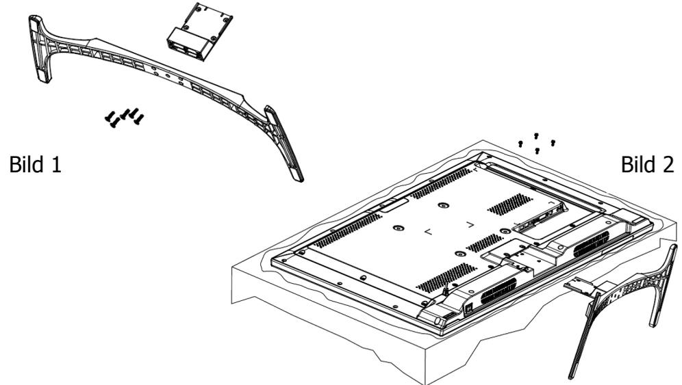
Legen Sie das Gerät mit der Bildschirmseite auf einen ebenen, weichen Untergrund. Achten Sie dabei darauf, dass kein Druck auf das LCD-Panel ausgeübt wird und dieses nicht beschädigt oder zerkratzt wird.
