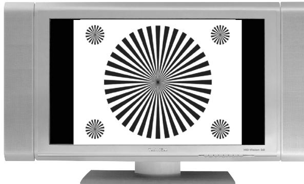
Die Einstellung **optimal** stellt einen Kompromiss dar. Das Bild wird unter beibehalten der Geometrie etwas vergrößert, wobei oben und unten etwas Bildinformation abgeschnitten wird. Das stört in der Regel nicht, da die Sendeanstalten in diesem Bereich meist keine wichtigen Informationen unterbringen, da herkömmliche Röhrengeräte aus technischen Gründen nie das gesamte Bild anzeigen. Es verbleiben in dieser Einstellung schmale schwarze Streifen links und rechts im Bild.
