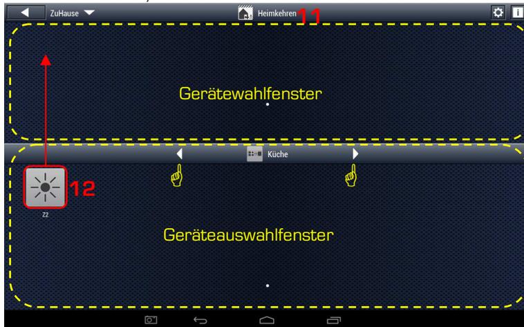
13. Durch berühren des ausgewählten Geräte-Icons, wird der Schaltzustand beim Auslösen der Szene festgelegt (hier: An ☀️ / Aus ☷). Wählen Sie also aus welchen Zustand der Aktor beim Auslösen der Szene haben soll. Wir wählen ‚An‘
