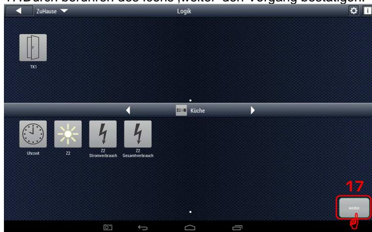
18. Durch berühren des weißen Feldes den Zustand des TK1 bestimmen, bei dem die Logik ausgeführt werden soll. TK1 bietet die Auswahl zwischen ,offen' und ,geschlossen'.
