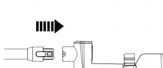
> Verbinden Sie anschließend das **Aluminium Saugrohr** inklusive der **Ladestation** mit der **Absaugstation**. Zum Trennen drücken Sie zunächst den Entriegelungsknopf und entnehmen Sie anschließend das Saugrohr.
