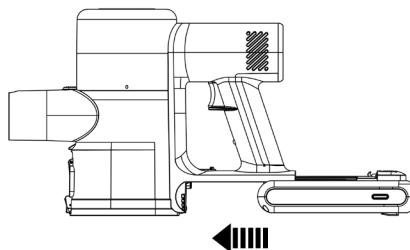
> Zum abnehmen des **Akkus** von der Motoreinheit, zuerst den **Entriegelungstaste** am Akku drücken und den Akku gleichzeitig von der Motoreinheit abziehen.
