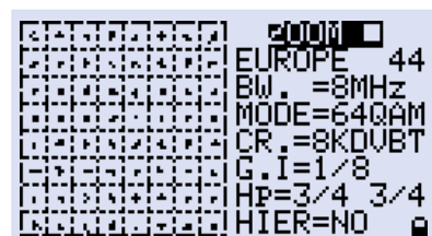
KONSTELLATION DVB-T-64QAM: DIE TABELLE RECHTS ZEIGT ALLE VERFÜGBAREN MODULATIONSPARAMETER
